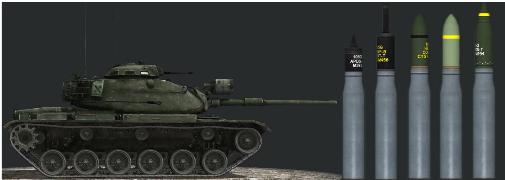
Рис.3.7 – Выстрелы к пушке М68, слева-направо: М392, М456, М393А1, М416, М494
