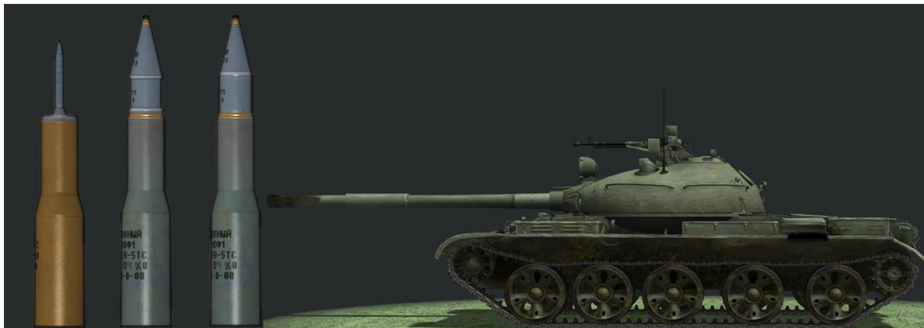
Рис.3.3 – Выстрелы к пушке У-5ТС, слева-направо: 3УБМ3, 3УБК3, 3УОФ1
